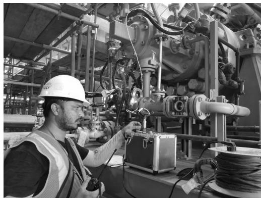
图 5 采用 TK-3 测试振动探头
